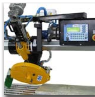
BRIDGE TILT AT 45 DEGREES ► Inclinazione ponte a 45°
